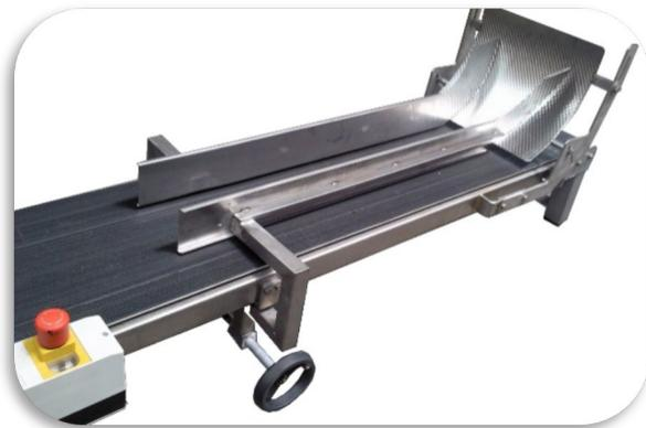
Caídas con regulación manual o de forma automática para posicionar el producto en la banda.
