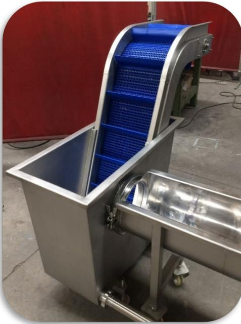
Cintas sumergidas. Cintas de inmersión total o parcial. Los componentes de la zona sumergida deben ser resistentes a las acciones que estos pueden provocar en los materiales de la cinta. Si los elementos de transmisión están situados en el exterior, un laberinto de cierres mecánicos sellará el sistema.
