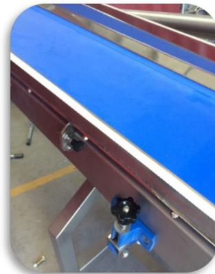
Tensores que permiten destensar y tensar la banda de forma rápida y sencilla, no es necesario posterior regulación ya que se mantiene la presión original. Idóneo para zonas sucias donde se requiera una limpieza profunda de forma habitual.
